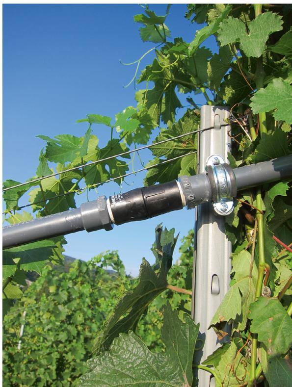
Abb. 4: Ein Druckregulator dient der Kompensation des hydrostatischen Druckes in der Steillagen-Anlage. Das Rebschutzmittel tritt auf der Hangoberseite aus dem mit einer Schraubenverbindung am Pfahl fixierten Rohr in den Druckregulator ein, vermindert seinen Druck beim Durchströmen der Armatur auf 2,5 bar und tritt mit vermindertem Druck Richtung Hangunterseite wieder aus.
