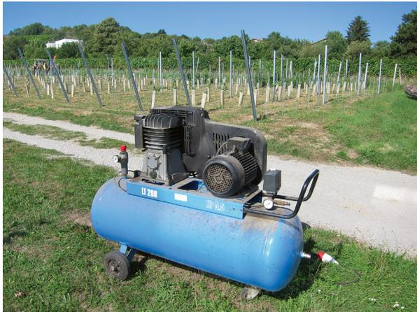
Abb. 11: Für die Mittelentfernung und Reinigung im Inneren der Applikationsanlage eignet sich Druckluft. Der dafür notwendige Druck wird von einem Kompressor mit 200-l-Druckluftbehälter aufgebaut.
