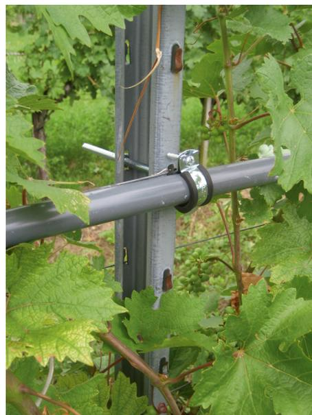
Abb. 8: Die Position der Polyvinylchlorid-Rohrleitung – vorgegeben durch die Rebenhöhe – ist mit einer Schraubenverbindung fixiert. Eine genaue Längsverteilung der Mittel lässt sich nur durch einen gleichbleibenden Abstand zwischen den Rohren in der Laub- bzw. Traubenzone erzielen.
