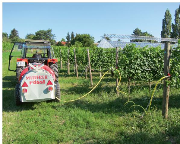
Abb. 5: Mithilfe eines mobilen Weinbau-Sprühgeräts erfolgt die Mitteleinbringung in die stationäre Applikationsanlage. Die Druckenergie reicht dabei aus, gleichzeitig mehrere Rebenreihen, hier sind es zwei Reihen, mit Rebschutzmitteln zu versorgen.
