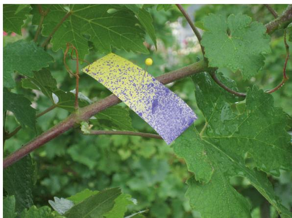
Abb. 12: Das Water-Sensitive-Paper detektiert durch einen Farbumschlag von gelb auf blau die angelagerten Rebschutzmittel. Dadurch lässt sich die Applikationsqualität ohne aufwändige Analytik direkt im Felde beurteilen.
