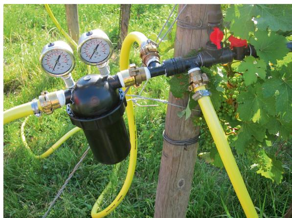
Abb. 6: Kopfstation einer stationären Applikationsanlage; der Filter dient der Vermeidung von Verunreinigungen und Fehldosierungen, die Federmanometer messen den Arbeitsdruck, und die Armaturen steuern den Volumenstrom in den Rohrleitungen.
