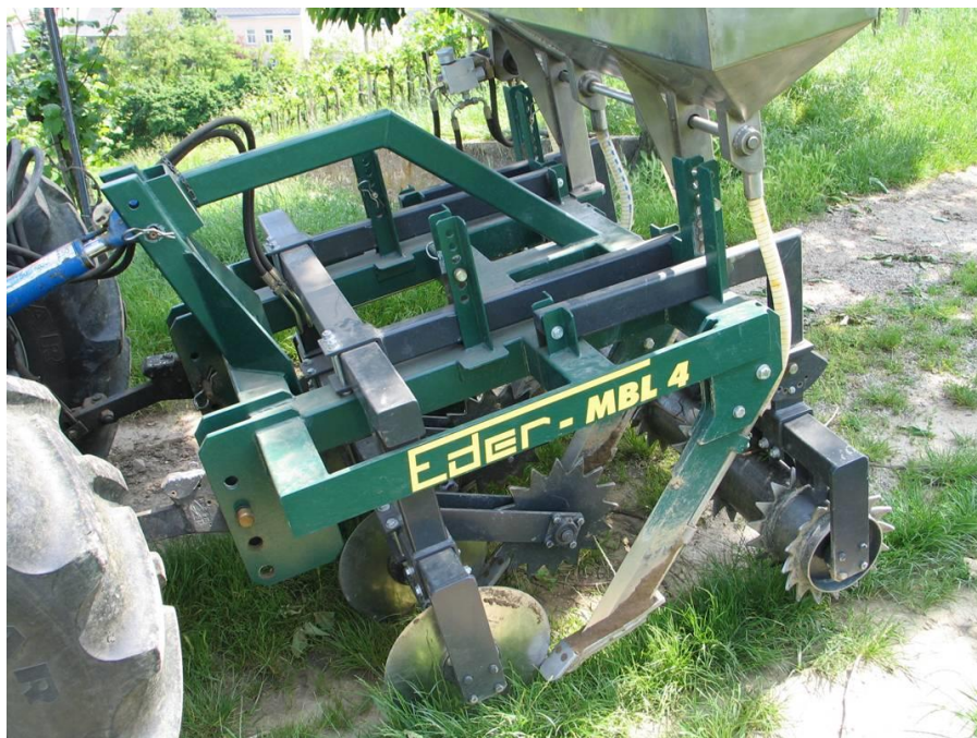
Abb. 1: Mulchbodenlockerer mit Düngerkastenaufsatz
