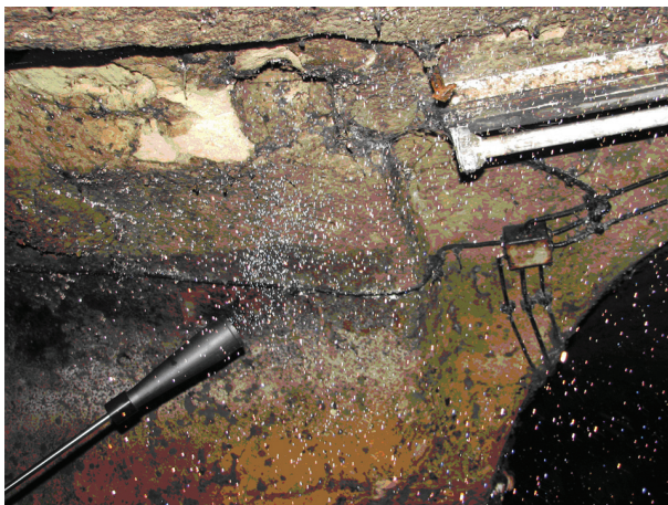
Abb. 1: Visualisierung von Strömungsfeldern mit Helium-Luft-Gemisch-Blasen im Weinkeller
