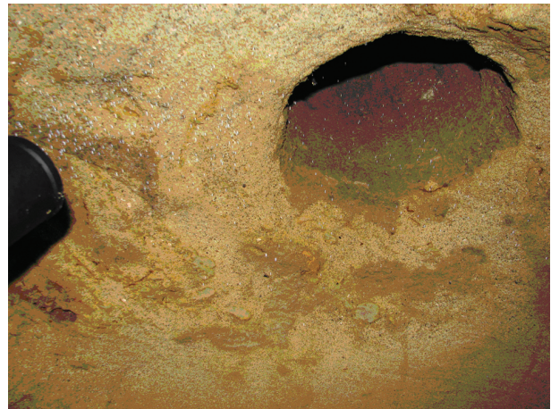
Abb. 2: Langsames Vorbeiströmen der Helium-Luft-Gemisch-Blasen an der Luftöffnung
