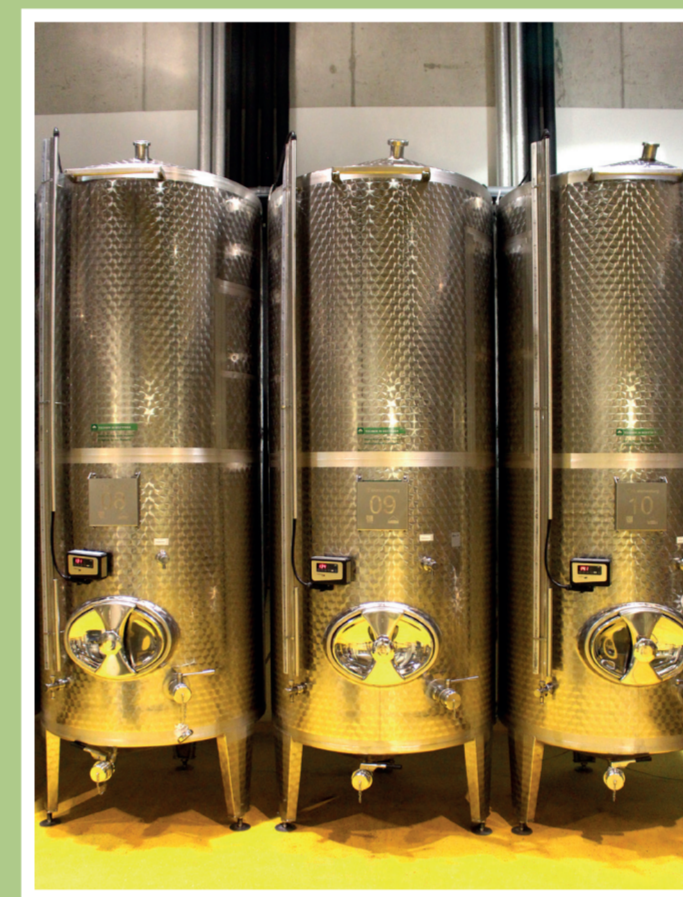
Modere Edelstahlanks mit Doppelmantelkühlung
