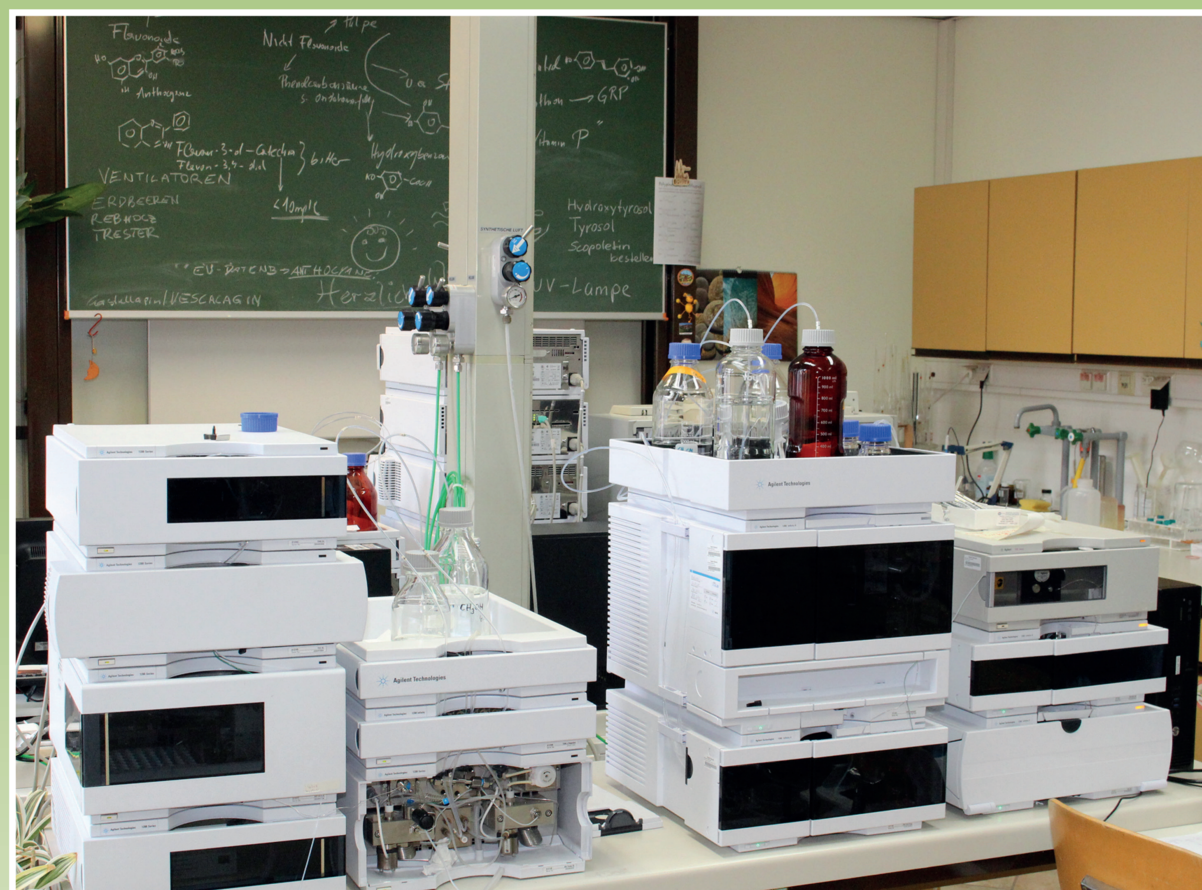
Phenolanalytik mittels HPLC (Foto: Karl Zitta, HBLA u. BA Klosterneuburg)
